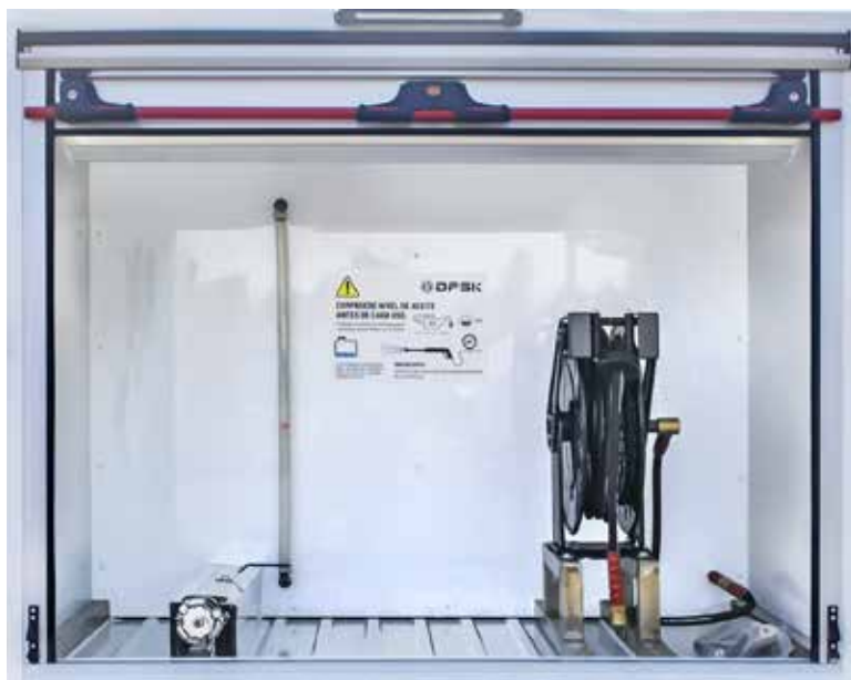
Zona enroladores e doseadores detergentes
