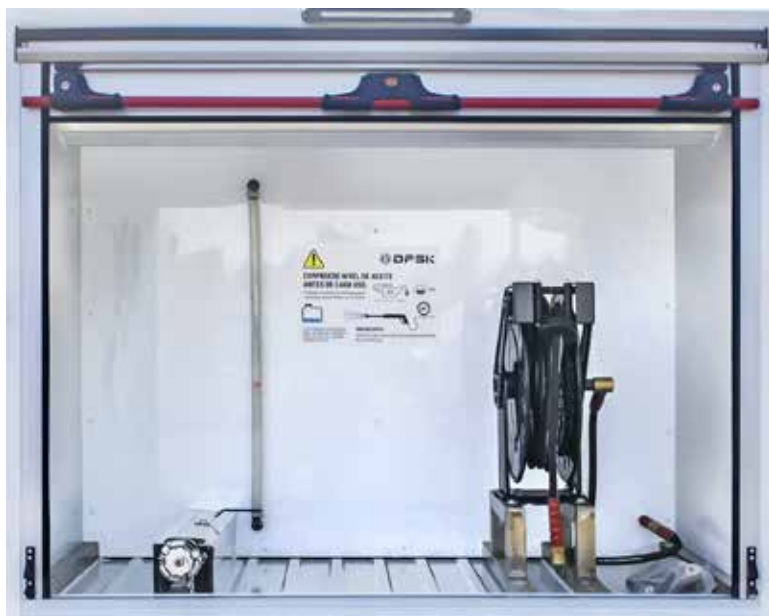
Zona enroladores e doseadores detergentes
